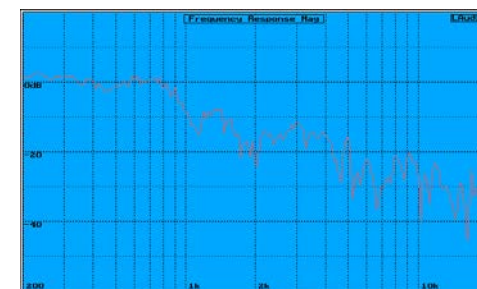
Réponse en fréquence de 200Hz à 20 kHz à 60°
